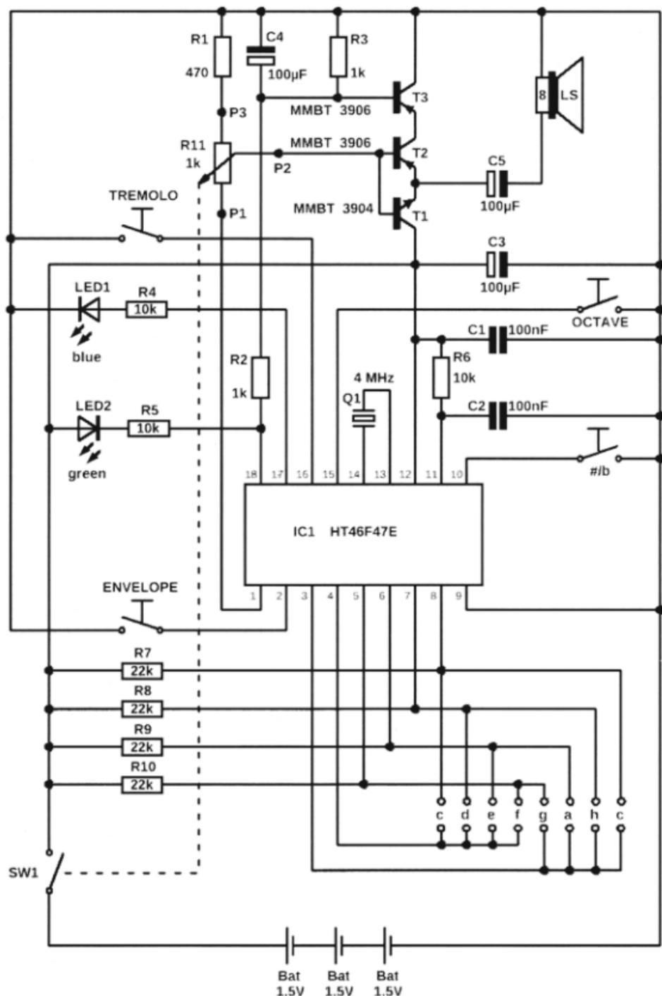
Bild 1: Die Schaltung des Synthesizers – übersichtlich um den Holtek HT46F47E angeordnet
