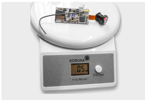
Bild 4: Die gesamte Einheit aus HD-Kamera, Bildverarbeitungssystem samt Speicherslot sowie Videosender des Hubsan H107D+ bringt gerade mal 5 g auf die Waage.
