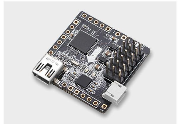
Bild 6: Weit verbreitet bei Selbstbau-Drohnen – das NanoWii-Board
