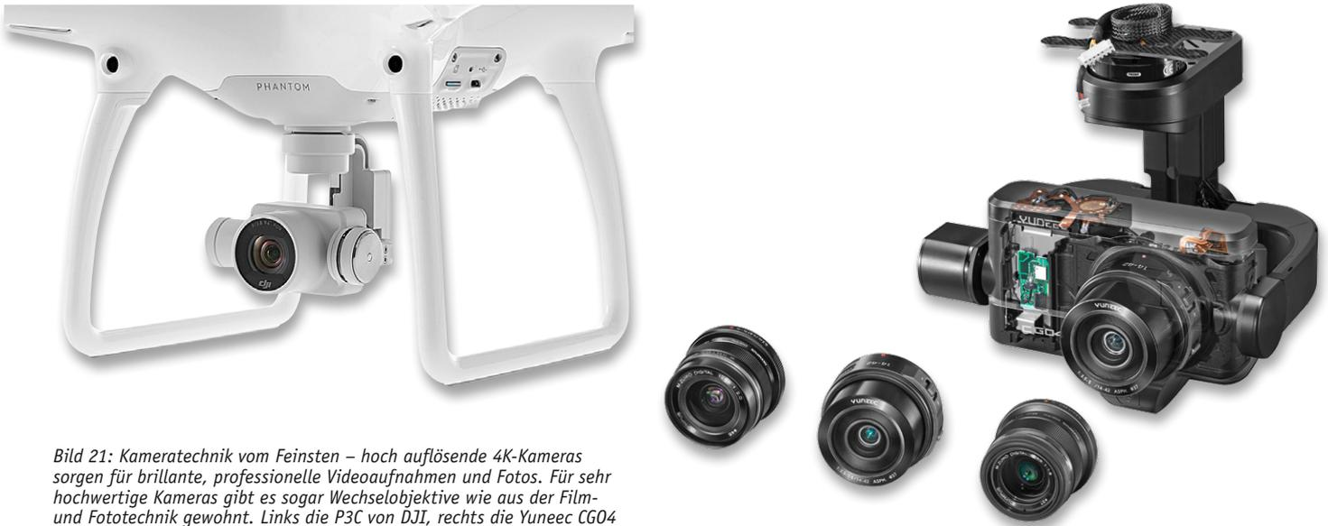
Bild 21: Kamertechnik vom Feinsten – hoch auflösende 4K-Kameras sorgen für brillante, professionelle Videoaufnahmen und Fotos. Für sehr hochwertige Kameras gibt es sogar Wechselobjektive wie aus der Film- und Fototechnik gewohnt. Links die P3C von DJI, rechts die Yuneec CG04
