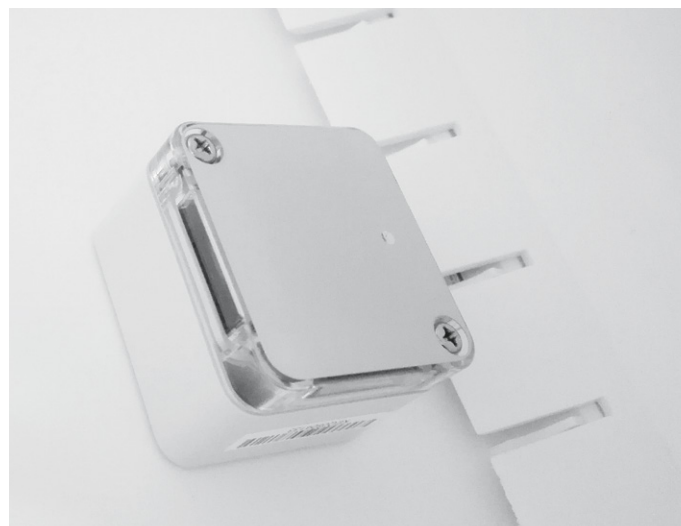
Bild 4: Anbringung des Homematic Funk-Neigungssensors in einem Paketkasten mit Klapptür
