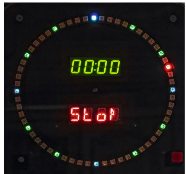
Bild 12: Betriebszustand 9 – die Stoppuhr läuft seit 12 Sekunden.
