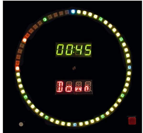
Bild 10: Anzeigebeispiel für den Rückwärtszähler, hier 45 Minuten
