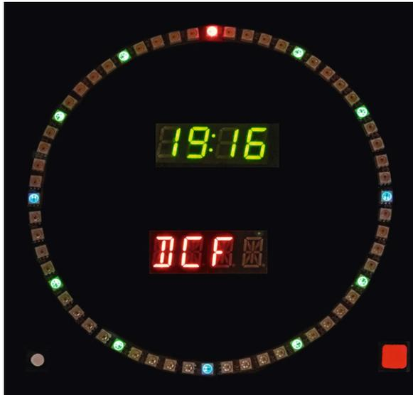
Bild 9: Die Uhrzeitanzeige – hier läuft die DCF77-Synchronisierung.
