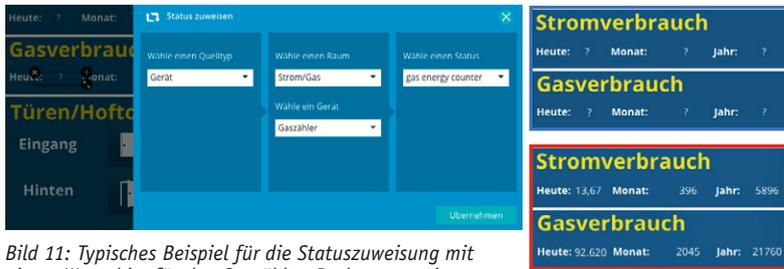
Bild 11: Typisches Beispiel für die Statuszuweisung mit einem Wert, hier für den Gaszähler. Rechts unten im rot umrandeten Bereich sieht man die Ausgabe in der App.
