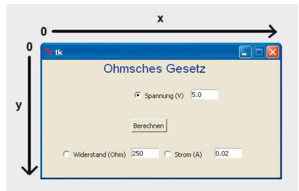
Bild 10: Rechner zum ohmschen Gesetz mit Place-Layout-Manager
