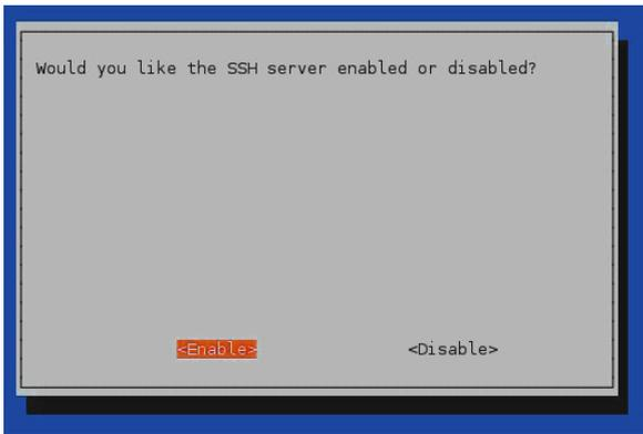
Bild 2: Einschalten von SSH im Konfigurationsmenü Rasp-Config
