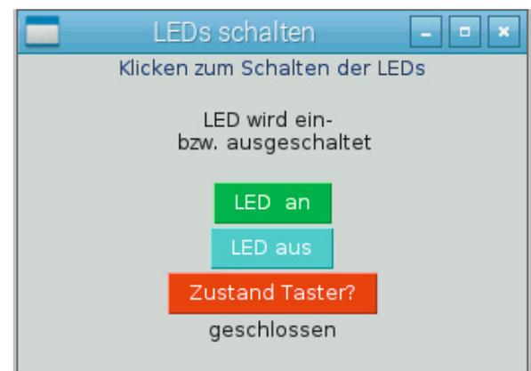
Bild 14: Tkinter LED an/aus und Taster abfragen
