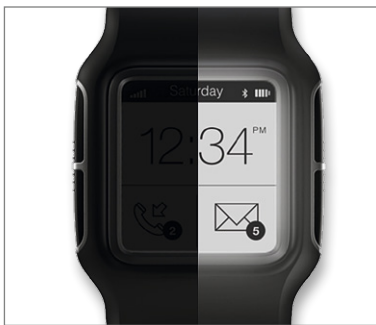
Abbildung 10: Im Dunkeln sind EPDs ohne Beleuchtung dunkel. Eine auf das Display aufgetragene transparente Leuchtfolie schafft Abhilfe (Quelle: FLEx LLC).
