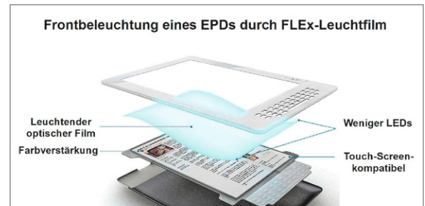
Bild 9: Die Leuchtfolie der amerikanischen Firma FLEx LLC wird direkt auf die Vorderseite eines reflektiven Displays gebondet.
