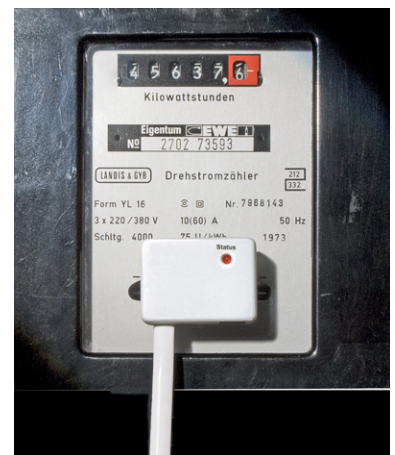
Bild 1: HomeMatic-Zählersensor Ferraris-Zähler „ES-Fer“
