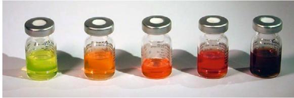
Bild 6: Von kurzwelligem Licht bestrahlte Quantenpunkt-Lösungen leuchten in langwelligeren Farben. (Quelle: Wikipedia)
