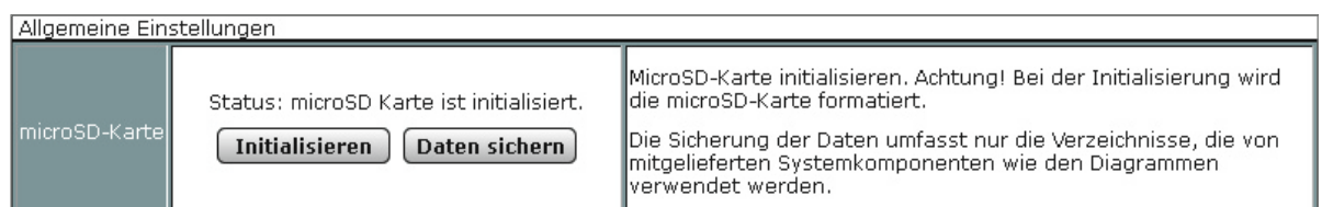
Bild 1: Über diesen Dialog in der CCU WebUI erfolgt die Initialisierung der Speicherkarte.
