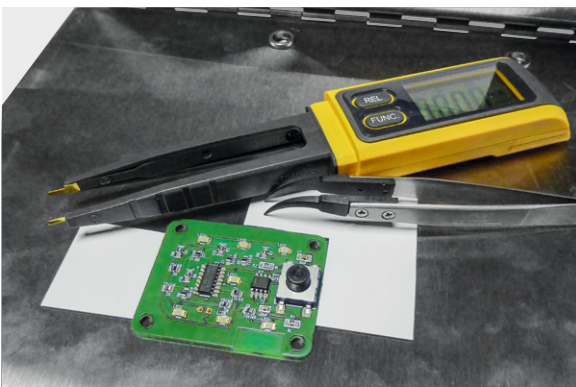
Bild 13: Die bestückte Platine. Im Hintergrund ein praktischer SMD-Bauteiltester.
