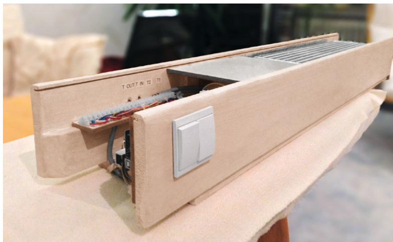
Bild 9: Über zwei Schalter werden die Betriebsarten eingestellt.
