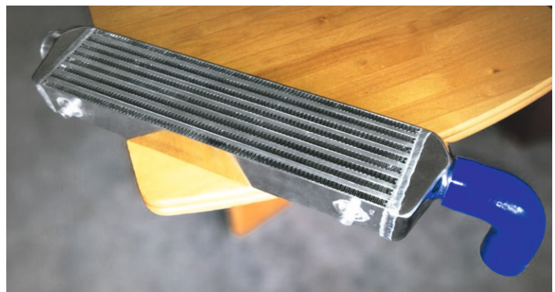
Bild 3: Als Wärmetauscher wird ein Ladeluftkühler eingesetzt.
