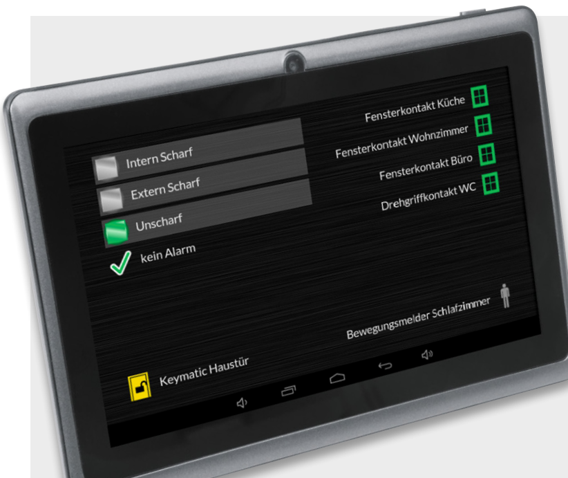
Bild 6: Das Easy SmartHome Display 7 fasst alle Alarmanzeigen, Meldungen und Zustände übersichtlich zusammen.
