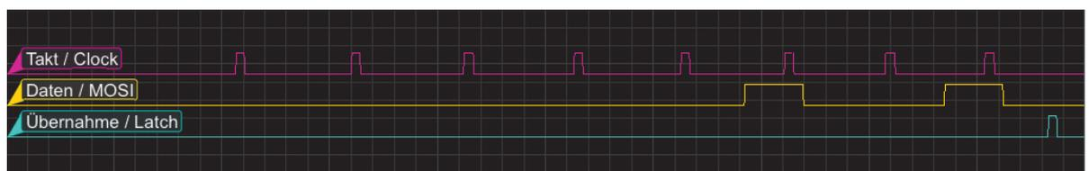
Bild 2: Signalverlauf 8-Bit-Schieberegister
