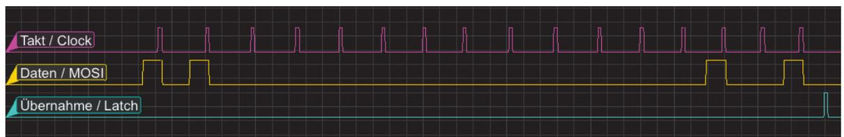
Bild 3: Signalverlauf 16-Bit-Schieberegister
