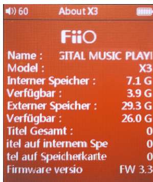
Bild 33: Die wichtigsten Informationen über den X3-Status. FW3.3 ist aktuell und ermöglicht die Nutzung externen SDHC-Speichers bis 128 GByte.
