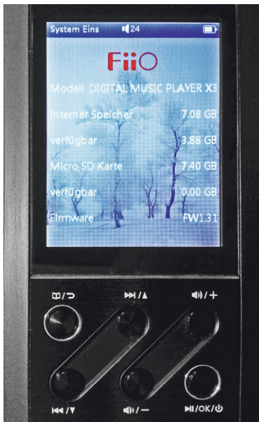
Bild 31: Erst ab Firmware-Version 2.05 ist der hochwertige Digital-Analog-Wandler des X3 auch mit extern über den USB-Anschluss zugespieltes Audiomaterial nutzbar. Die aktuelle FW-Version ist 3.3.
