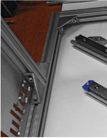
Bild 7: Robuste Verschraubungen sichern einen sehr steifen Aufbau des Rahmens.
