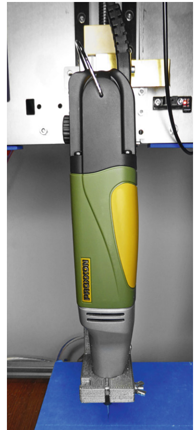
Bild 20: Die Frässpindel ist blitzschnell an der Z-Achse montiert.
