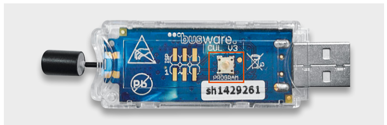
Bild 1: Die Lage der „Program“-Taste auf dem CUL-Stick
