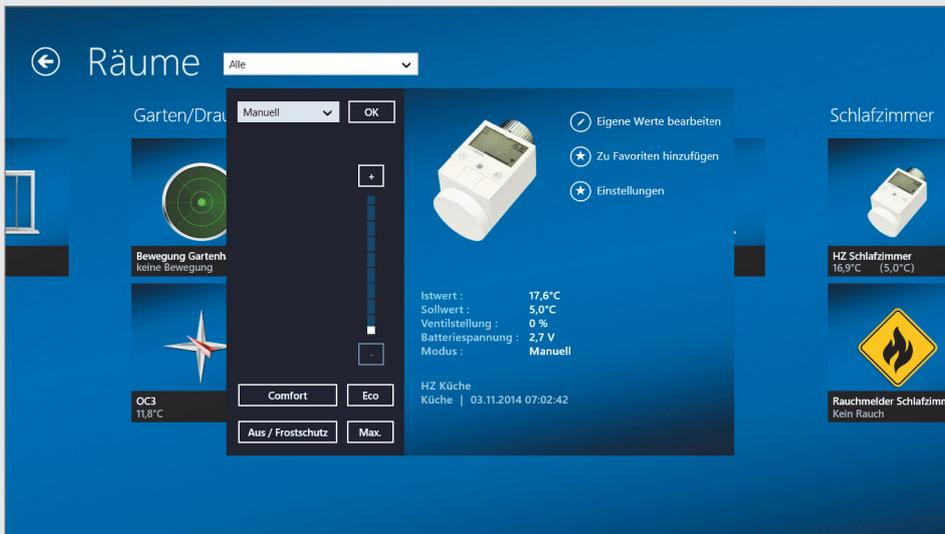
Bild 20: Einstellung eines HomeMatic-Heizkörperthermostaten
