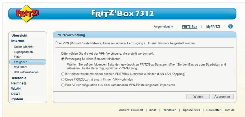
Bild 3: Anlegen einer VPN-Verbindung am Beispiel einer AVM FRITZ!Box
