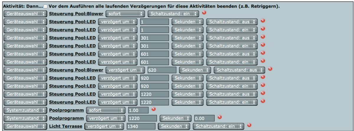
Bild 14: Das Programm zur Automatisierung bei der Pool-Benutzung
