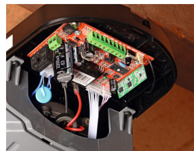
Bild 2: Der Garagentorantrieb DoorLift BASIC 60 bietet auf seiner Anschlussleiste alle benötigten Anschlüsse für die Fernsteuerung. Details zeigt Bild 3.
