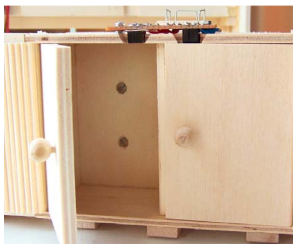
Bild 8: Ansicht der Anordnung von 2 Reflexkopplern an den Türkanten eines Doppelfaches
