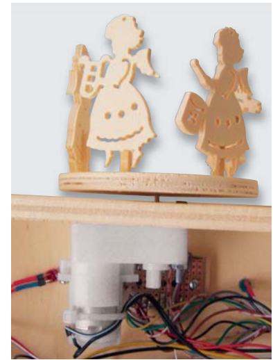
Bild 12: Getriebemotor mit Drehscheibe und aufgesteckten Pyramidenteilen
