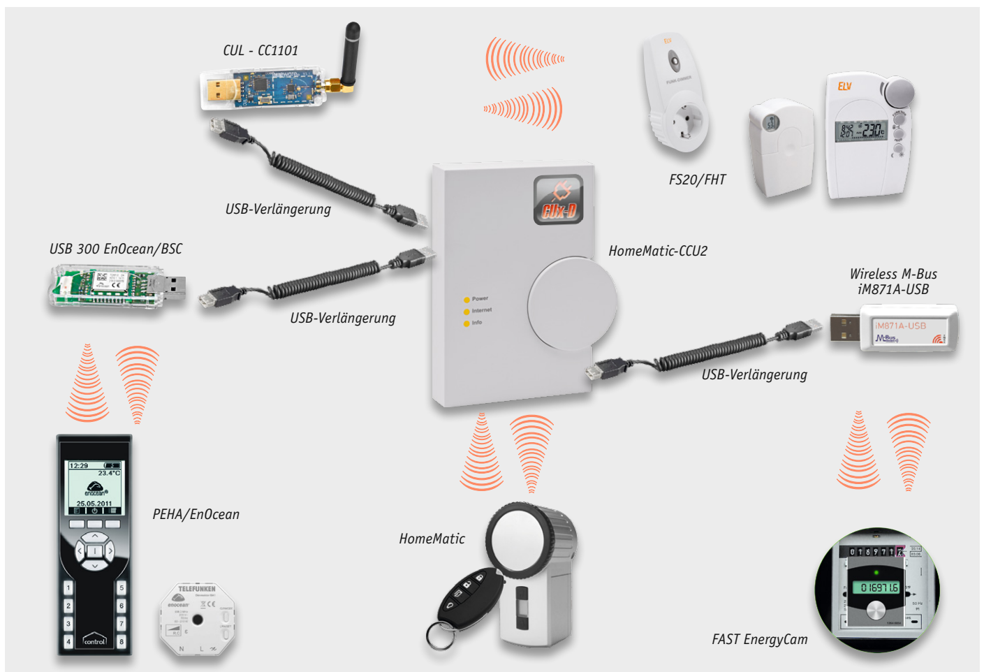
Bild 2: Beispiel für die Systemvielfalt, die über CUXD in das HomeMatic-System einbindbar ist. Quelle: ELV, Busware, PEHA/EnOcean, Telefunken, Wireless Solutions, FAST Forward
