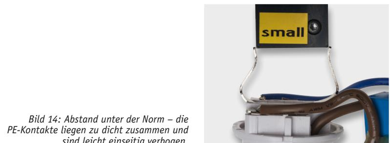
Bild 14: Abstand unter der Norm – die PE-Kontakte liegen zu dicht zusammen und sind leicht einseitig verbogen.
