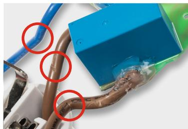
Bild 10: Können Folgeschäden nach sich ziehen: bei der Montage beschädigte Isolierungen
