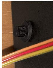
Bild 4: Der in einem LED-Halterung untergebrachte Temperatursensor
