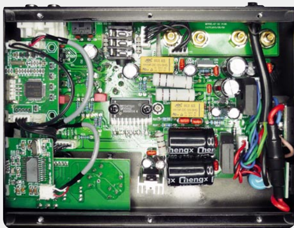
Bild 1: Der Blick ins Innere offenbart die Schaltung – als Endverstärker dient ein TDA1521, links die USB-Schnittstelle und darüber der MP3-Player.
