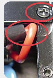
Bild 5: Unsichere Erdungsverbindung und Gefahr für die Isolierung der Netzleitung an der scharfen Kante
