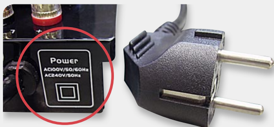
Bild 2: Falsch gekennzeichnet – das Gerät ist in Schutzklasse I ausgeführt
