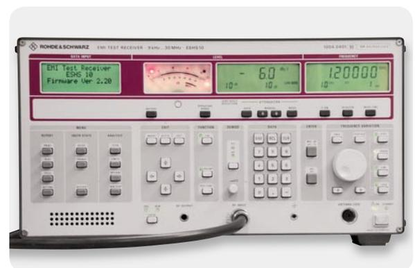
Bild 1: Hochempfindlich und präzise: Messempfänger bis 30 MHz ESHS10 von Rohde & Schwarz
