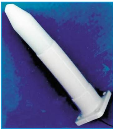
Bild 6: Feed mit dielektrischer Linse
