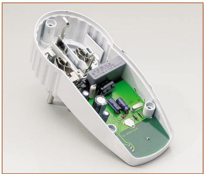
**Bild 3: Aufgebaute Platine im Stecker-Steckdosen-Gehäuse**
