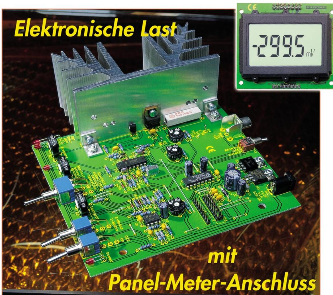
**Die hier vorgestellte elektronische Last dient zum Testen von Netzgeräten, beliebigen anderen Stromquellen, sowie für die definierte Entladung von Akkus. Es lässt sich sowohl ein fester elektronischer Widerstand als auch ein konstanter Strom einstellen.**
