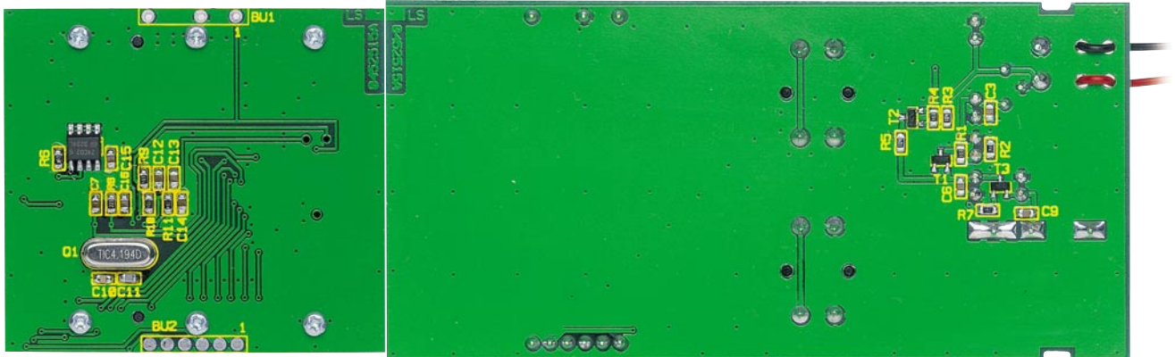
Ansicht der fertig bestückten Platine des USF 1000 E mit zugehörigem Bestückungsplan, oben von der Bestückungsseite, unten von der Lötseite
