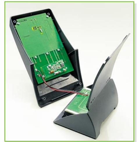
**Bild 18: Die Verdrahtung der beiden Platinen**
