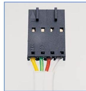
**Bild 6a:** Die Zuordnung der Adernfarben am Modulstecker
