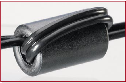
Bild 10: Fädung der Ausgangsleitung durch den Ferritkern
