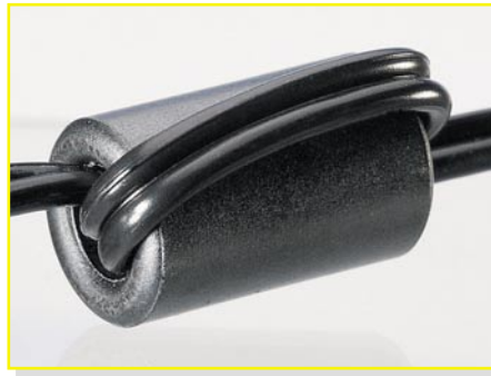
Bild 4: Fädung der Eingangsleitung durch den Ferritkern
