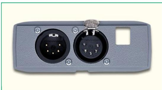
**Bild 8: Frontansicht der mit den XLR-Verbindern bestückten vorderen Stirnplatte**
