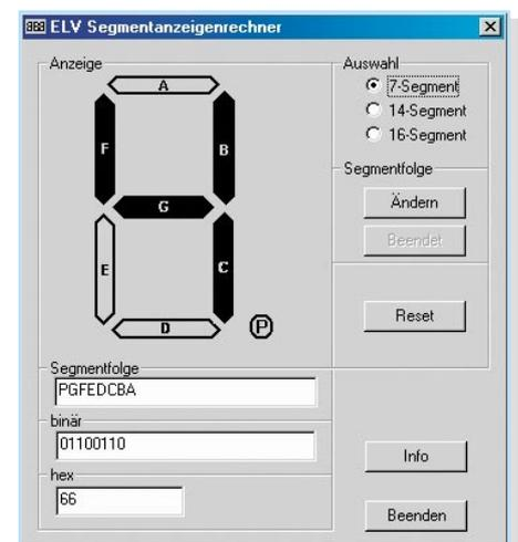
**Bild 4: Die Bedienoberfläche des ELV-Segmentanzeigen-Rechners**
