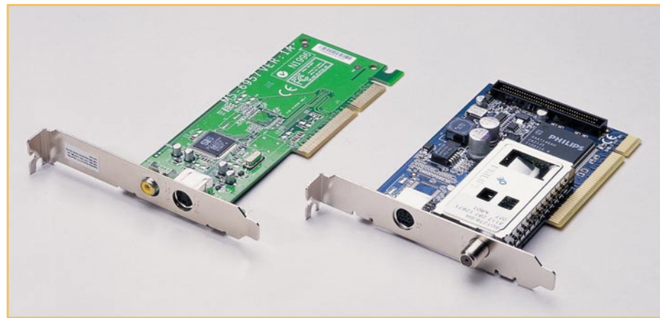
Bild 6: Die beiden verwendeten Steckkarten: links die TV-out-Karte, rechts die DVB-S-Karte
