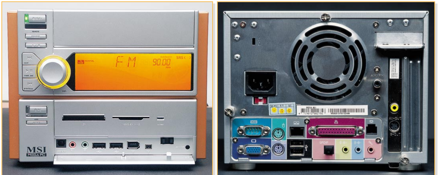
Bild 3: Schnittstellen komplett – vorn die öfter zu erreichenden, hinten komplett mit LAN, Modem und optischem Sound-Ausgang
