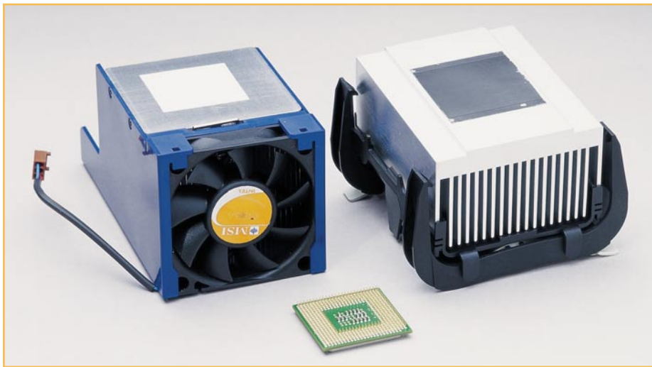
Bild 5: Der CPU-Kühler, links der Spezialkühler für den MEGA 651, rechts der original Celeron-Kühler
