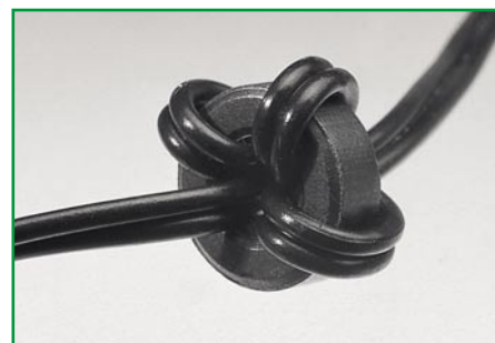
Bild 3: Die mit einem Ferrit präparierte Messleitung
