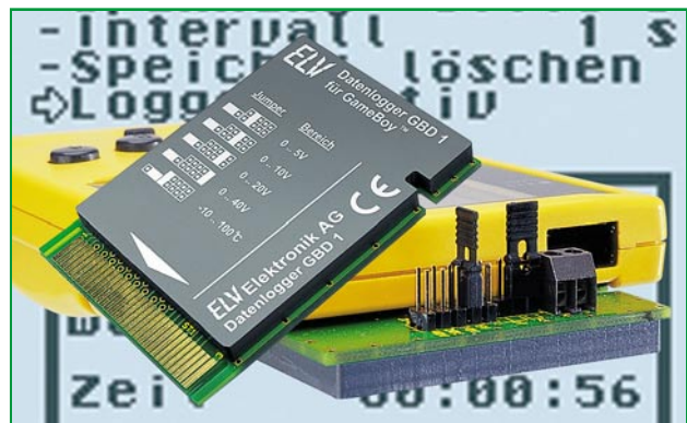
Fertig aufgebauter Datenlogger
