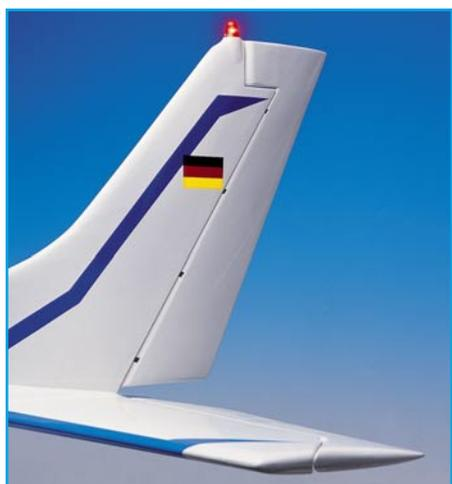
**Bild 2: Seitenleitwerk mit installiertem Anti-Kollisionslicht**
