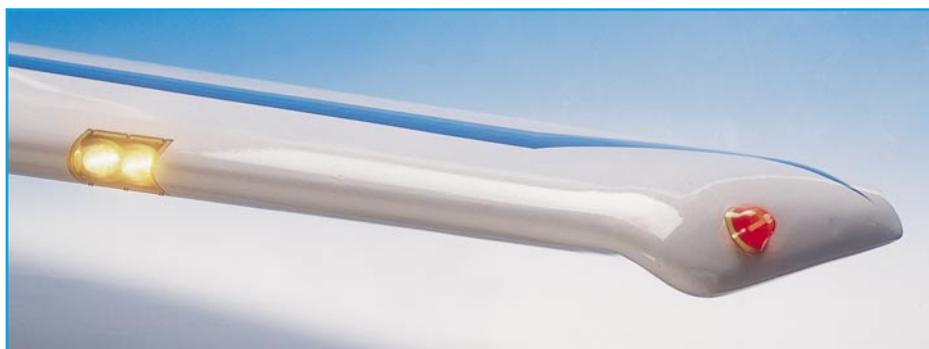
**Bild 3: Tragfläche mit Landeleuchten und Positionslicht**
