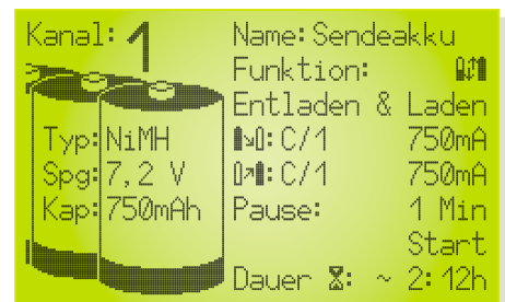
Bild 5: Kanalfenster für Kanal 1, Funktion gestoppt
