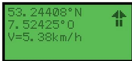
**Bild 6:** Die Positionsanzeige mit Geschwindigkeit und Kompasspfeil
