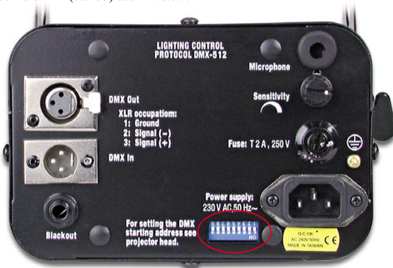
Bild 4: Die Adressierung erfolgt entweder per einfachem DIP-Schalter wie hier gezeigt, oder mit Hilfe von Displays, wie in Bild 8 zu sehen. Hier ist ein Beispiel mit XLR-3-Durchschleifbus zu sehen. Die Belegung ist noch einmal direkt am Gerät angebracht. Foto: Steinigke Showtechnik
