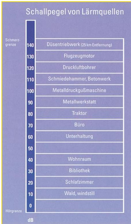
**Bild 1: Die Skala der im Alltag vorkommenden Schallpegel (Quelle: Sennheiser)**
