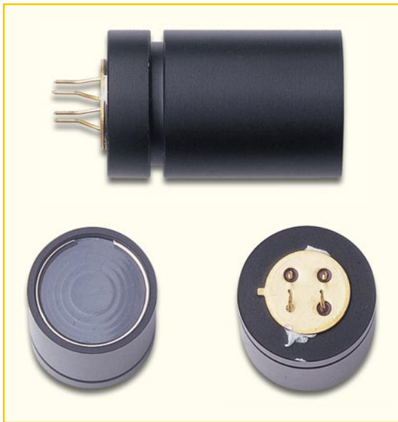
Bild 5: Ansicht der fertig montierten Linse
