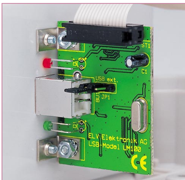
Bild 6: Montagebeispiel des UM 100 in einer Rückwand
