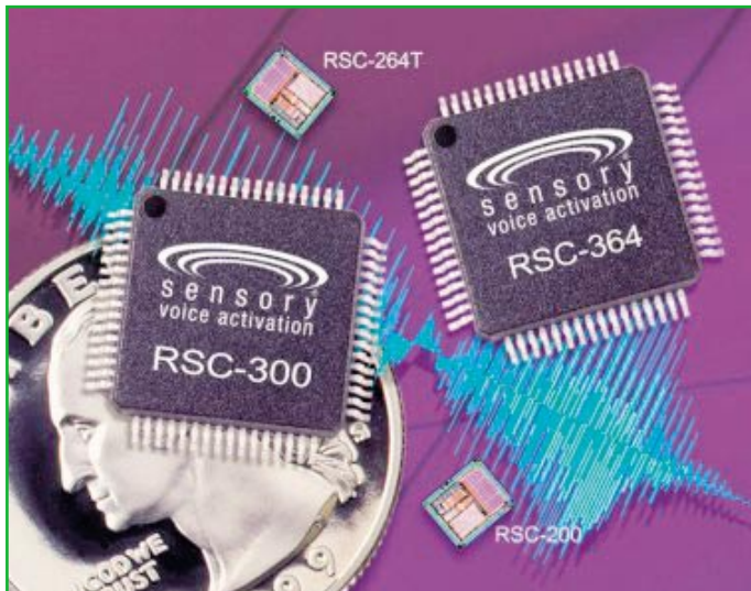
Bild 1: Im Gegensatz zum RSC 300 ist beim RSC 364 ein 64-kB-ROM vorhanden.
