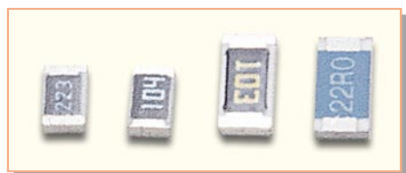
Bild 1: SMD-Widerstände in unterschiedlichen Größen (0805 und 1206).
