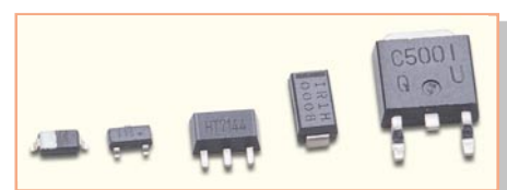
Bild 7: Dioden werden je nach Leistungsklasse in unterschiedlichen Gehäuseformen geliefert.
