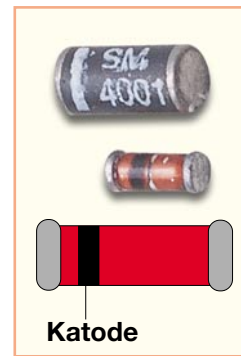
Bild 6: Standard bei Universaldioden - das MELF-Gehäuse
