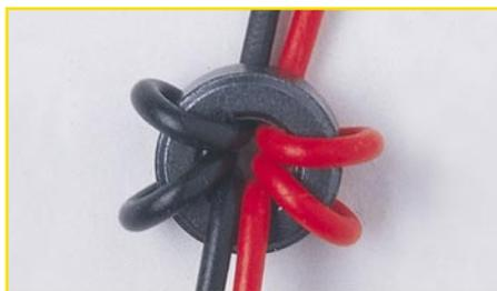
**Bild 4: Fertig gewickelte stromkompensierte Ringkerndrossel**
